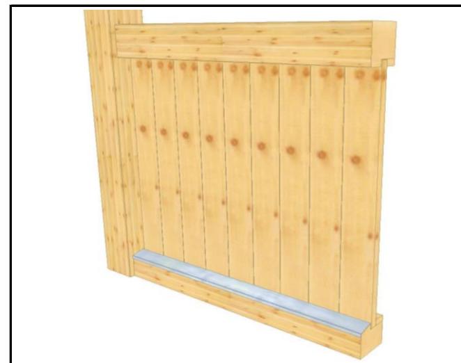
01.1.6 Brüstungsfüllung mit Alu - Tropfkante unten >> eingefräst bestehend aus Ober- und Untergurt, Füllung Fichte / Lärche schlicht senkrecht gestäbt Stabbreite 12 cm / ohne Lücke
