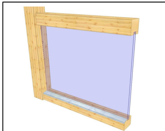
01.1.5 Wandverglasung mit Alu - Tropfkante unten >> eingefräst VSG - Verglasung 6 mm
