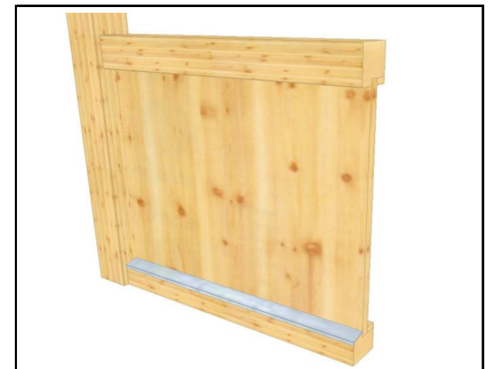
01.1.8 moderne Plattenfüllung mit Alu-Tropfkante unten >> eingefräst bestehend aus Ober- und Untergurt Füllung Fichte 3-Schichtplatte 21mm >> Sichtqualität, geschliffen
