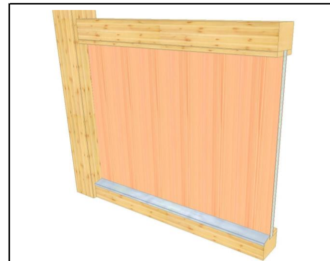
01.1.3 Holz-Sandwich-Platte bestehend aus hochwertiger Holzdecklage und hochdämmendem PU-Kern Stärke 30 mm Uw 1,0 W/m²K
