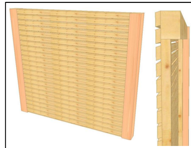
01.1.7 Rhombusschalung, offen zwischen den Stützen montiert sib. Lärche 70 x 21 mm / Lücke 15 mm sib. Lärche 56 x 27 mm / Lücke 15 mm >> Sichtqualität, gehobelt Ober- und Untergurt KVH 8 x 12 cm senkrechte 8 x 8 cm
