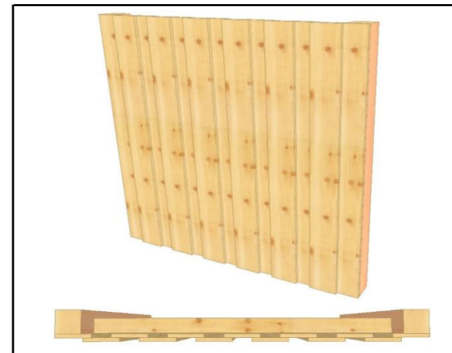
01.1.3 Deckelschalung, senkrecht Unter- u. Deckbrett Fichte 19 x 170 mm >> Sichtqualität, gehobelt Ober- und Untergurt KVH 8 x 12 cm
