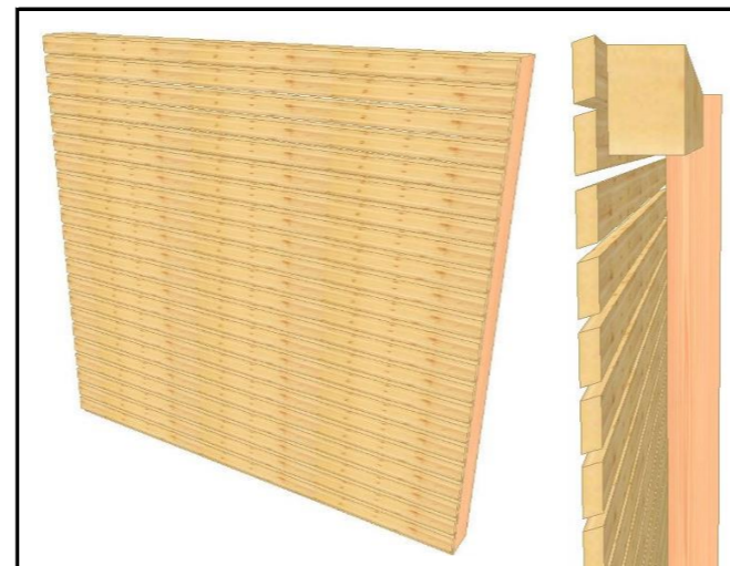
01.1.6 Rhombusschalung, offen vor den Stützen montiert sib. Lärche 70 x 21 mm / Lücke 15 mm sib. Lärche 56 x 27 mm / Lücke 15 mm >> Sichtqualität, gehobelt Ober- und Untergurt KVH 8 x 12 cm senkrechte 8 x 8 cm
