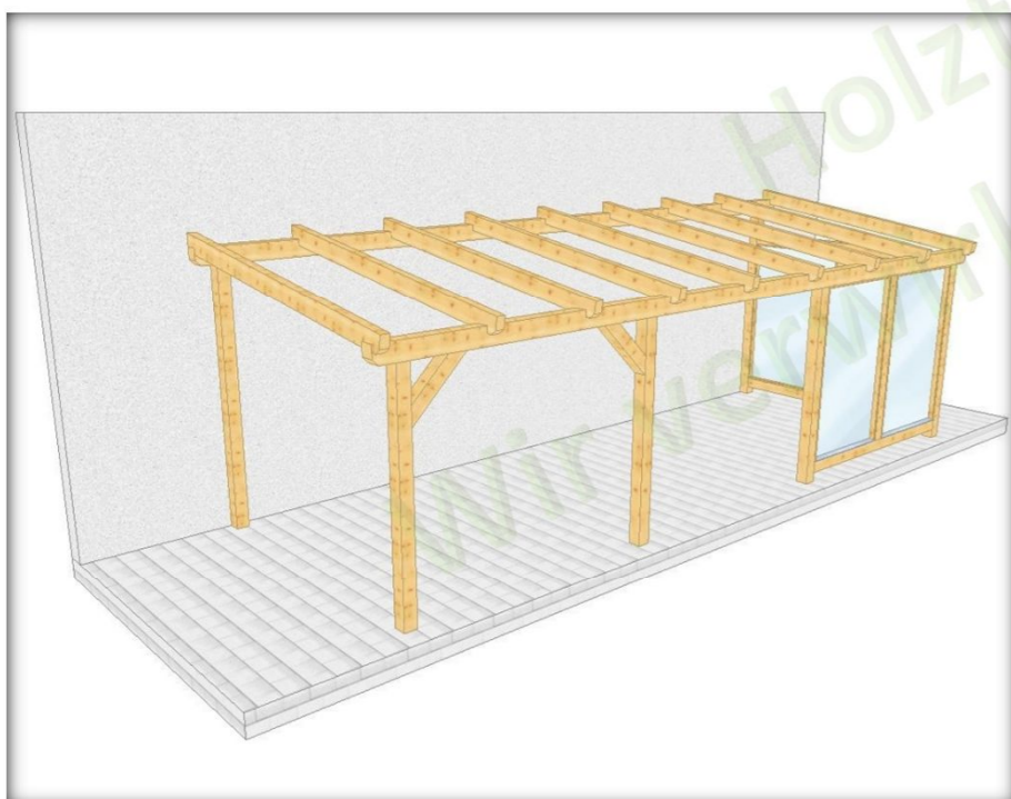
016 3 Überdachung am Haus mit 4 Stützen, mit Wandverglasung
