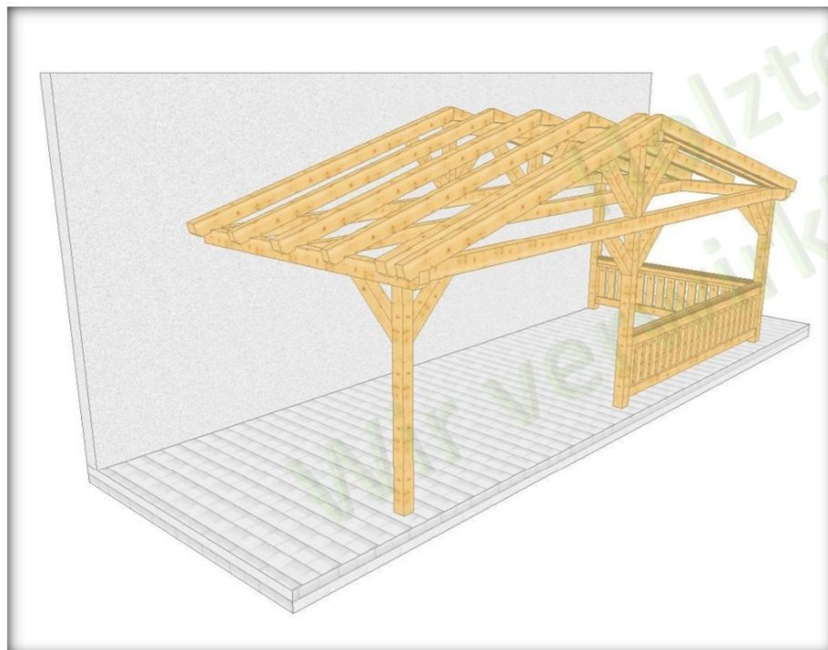
008 3 Überdachung am Haus mit 3 Stützen, mit Geländer
