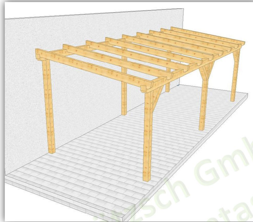
002 3 Überdachung am Haus mit 3 Wandstützen, Pulldach
