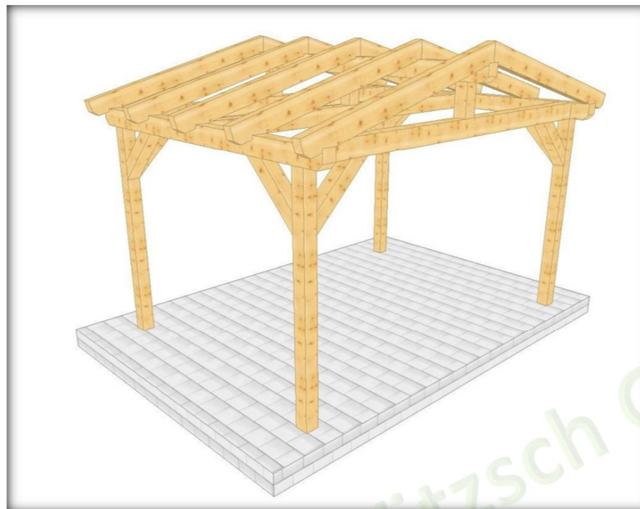
001 3 Überdachung freistehend mit 4 Stützen, Satteldach
