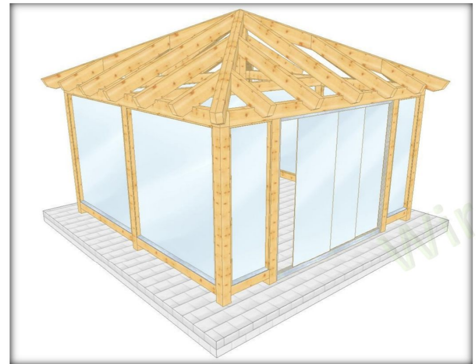
011 3 Überdachung frei 9 Stützen, Verglasung, Schiebetür, Walmdach
