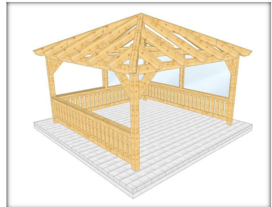
005 3 Überdachung frei 4 Stützen, Verglasung, Geländer, Walmdach
