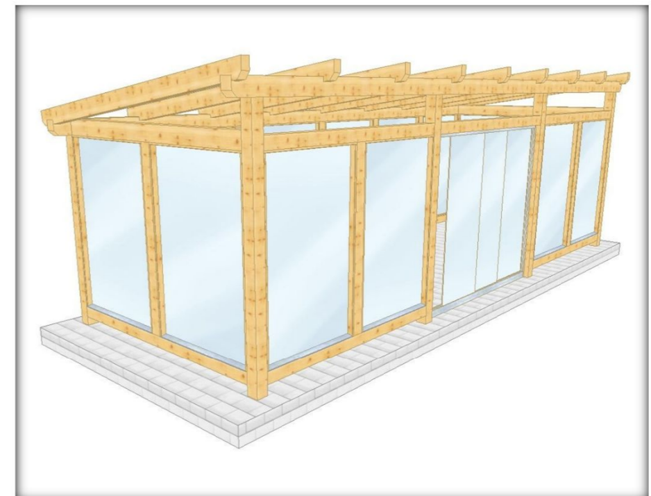
016 3 Überdachung frei 8 Stützen , Verglasung, Schiebetür, Pultdach
