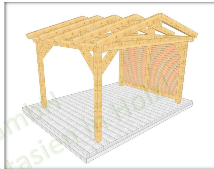
002 3 Überdachung freistehend 4 Stützen, Wandschalung, Satteldach
