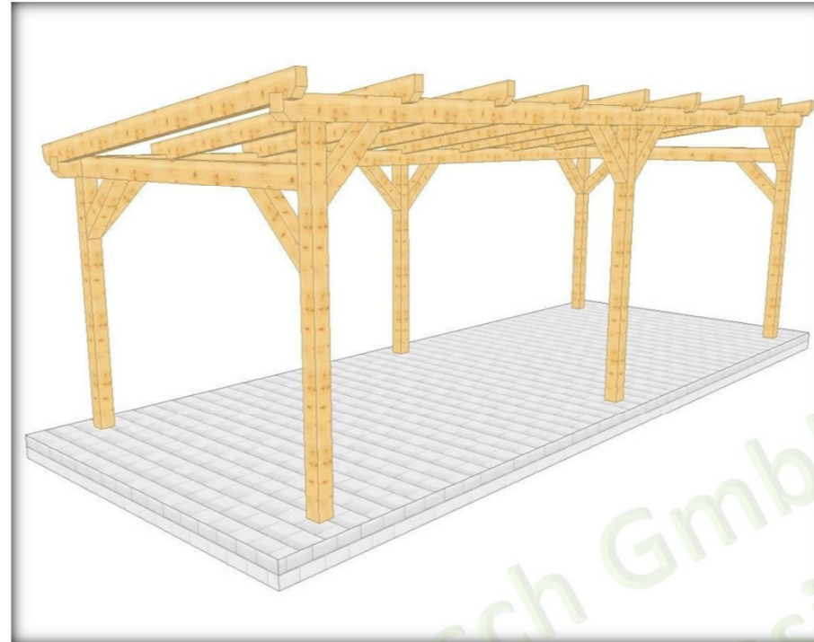
006 3 Überdachung freistehend mit sechs Stützen, Pultdach
