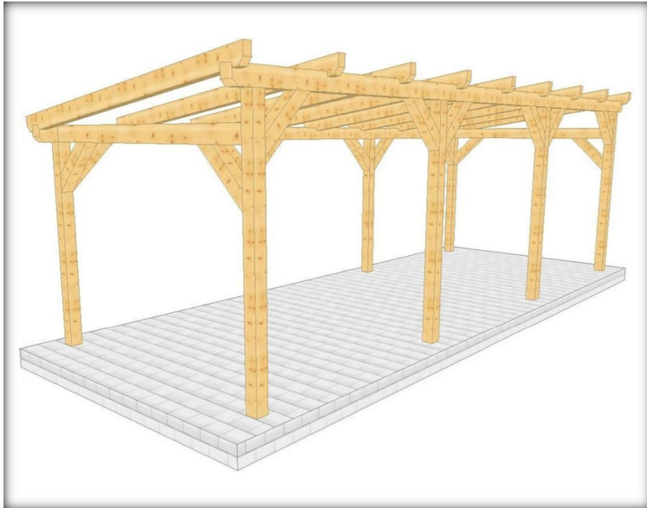
011 3 Überdachung freistehend mit 8 Stützen, Pultdach
