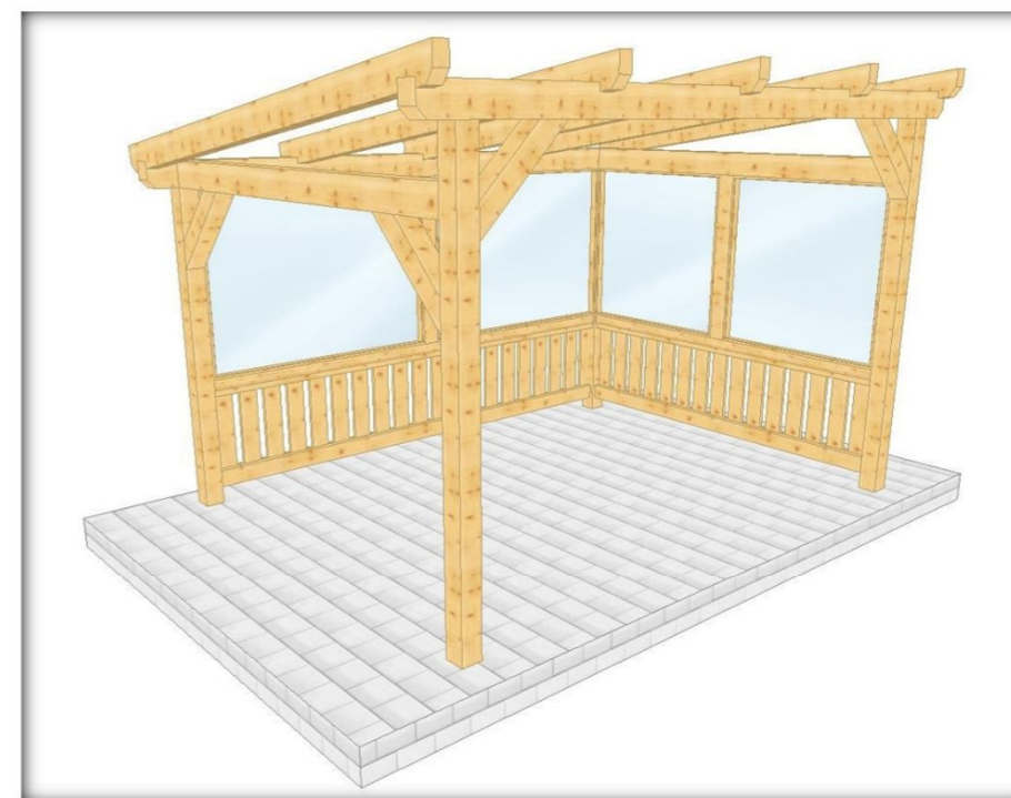
005 3 Überdachung frei. 4 Stützen, Wandverglasung, Geländer, Pultdach
