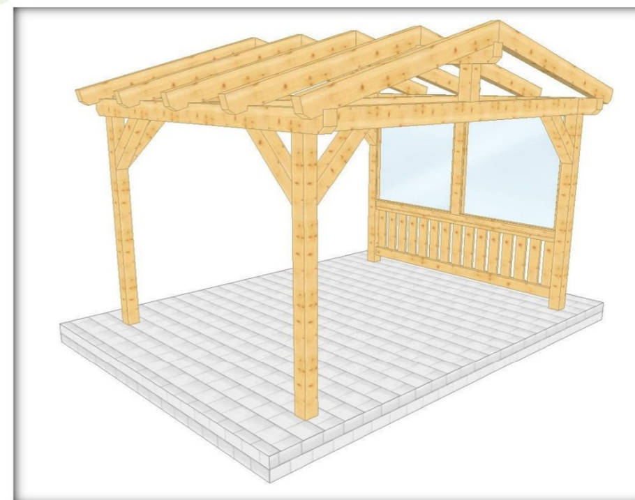
005 3 Überdachung frei 4 Stützen, Verglasung, Geländer, Satteldach
