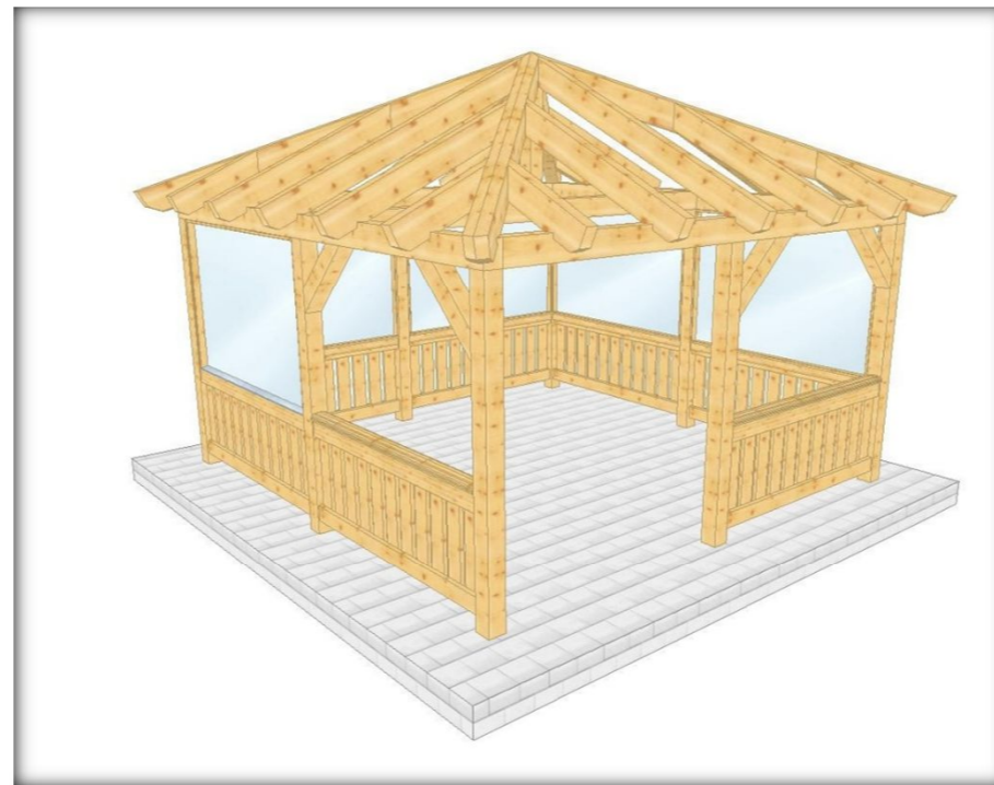
010 3 Überdachung frei 8 Stützen, Verglasung, Geländer, Walmdach
