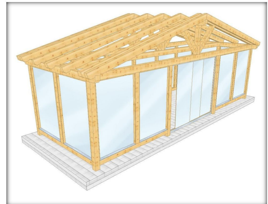
016 3 Überdachung frei 8 Stützen, Verglasung, Schiebetür, Satteldach
